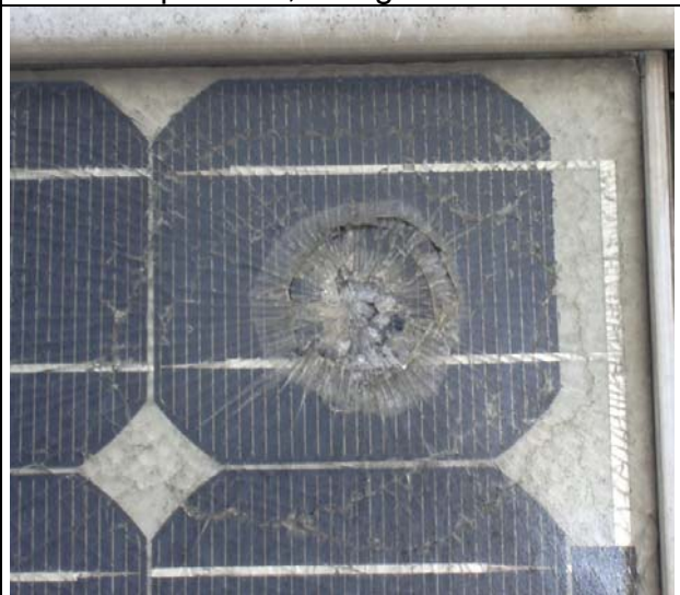
Das ist die Folge, wenn Krähen Module mit Steinen bombardieren
